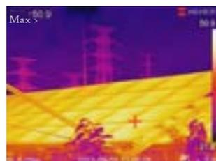
Inspección de paneles solares
